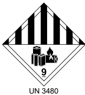
Abb. 11 Gefahrgut-Kennzeichnung von Lithium-Ionen-Batterien
